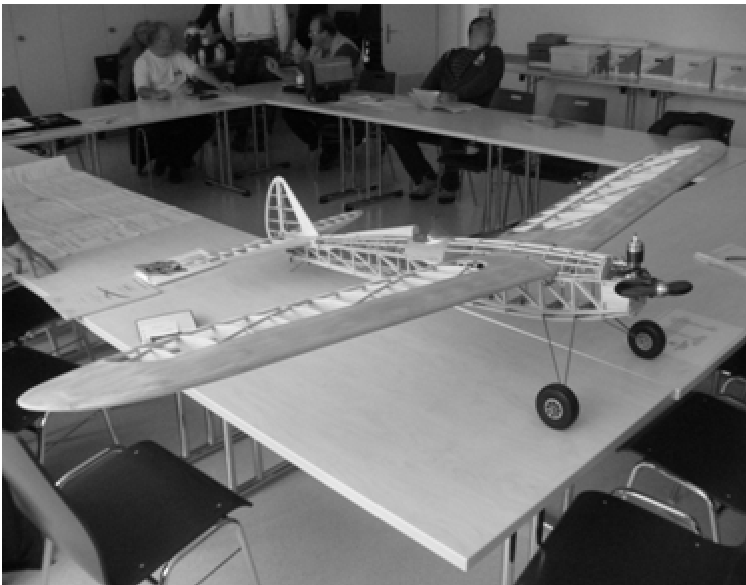
Peter Renggli's Cumulus 1937 mit einem Kratmo 10 ccm-Motor mit Drossel . Den Motor und die Drossel hat er selbst gebaut. Das Modell hat eine Spannweite von 2,40 m.
