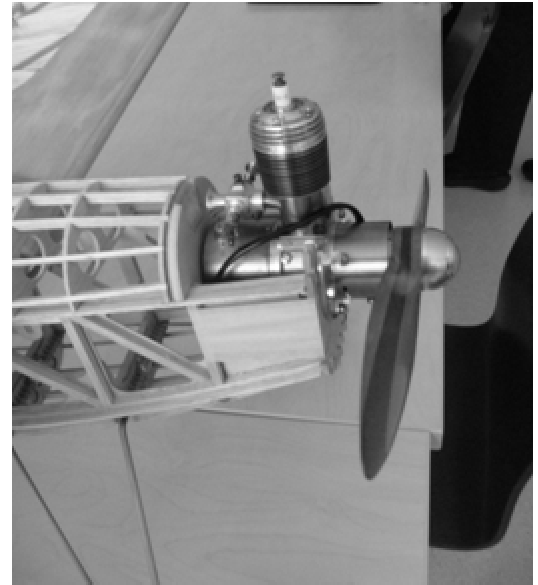
Peter Renggli's Cumulus 1937 mit einem Kratmo 10 ccm-Motor mit Drossel . Den Motor und die Drossel hat er selbst gebaut. Das Modell hat eine Spannweite von 2,40 m.
